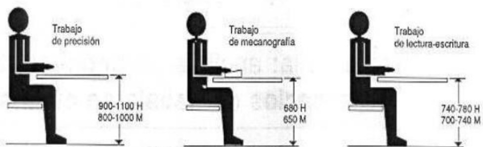
Fig. 1: Altura del plano de trabajo para puestos de trabajo sentado (cotas en mm)
